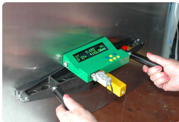
Портативный голографический радиусомер (ПГР-10 000), измеряющий диаметр изделий от 800 до 10 000 мм с дискретностью отсчета 1 мкм
