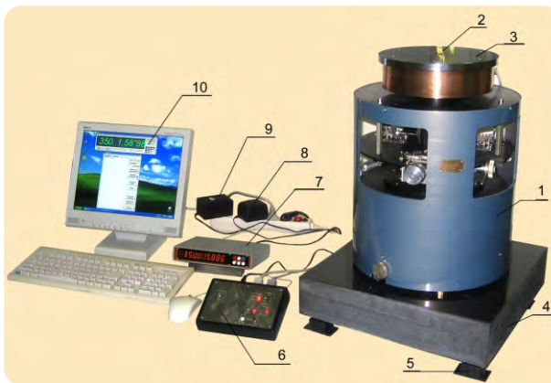
Двухшпиндельный наноизмерительный поворотный стол (ДШ НАНО ИПС). Разрешение 0,01 угл. с
