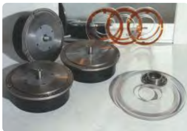
Голографические угловые датчики (ГУД-100) и круговые голографические дифракционные решетки (КГДР-100) диаметром 100 мм
