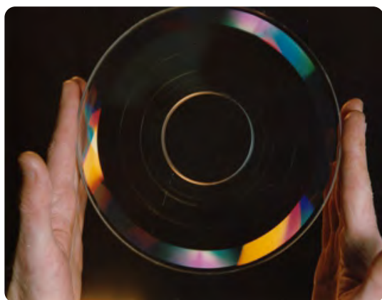
Радиальная голографическая дифракционная решетка (РГДР)
