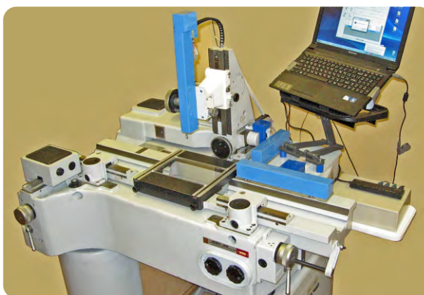
Трехкоординатная наноизмерительная машина на базе универсального измерительного микроскопа-23 (3D НАНО КИМ – УИМ-23).
